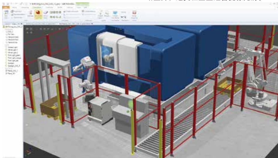
借助ABB仿真和离线编程软件RobotStudio，用户可在办公室的PC机上完成机器人编程，无需中断生产
