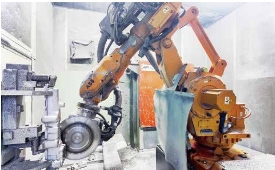
运动自适应控制器根据IRB 6660所受外力调整其动作
